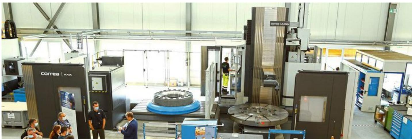
*La Correa Axia 70 et ses deux plateaux tournants, utilisés pour l'usinage pendulaire de larges composants.*
